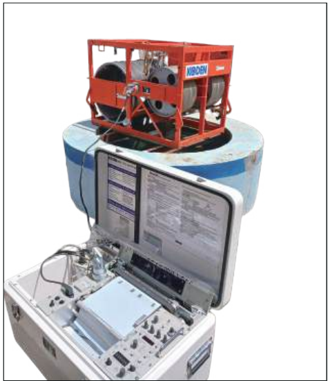
掘削孔の上にセットされたウインチ(上) ケーブル接続された記録機(下)
