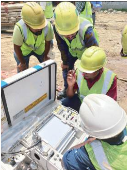
超音波側壁測定装置が現場で利用される様子
