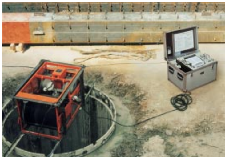
掘削孔の上にセットされたウインチ (左) ケーブル接続された記録機 (右)
