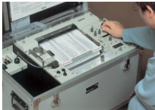
掘削孔エコーの記録
