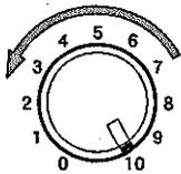
◎機能設定の“TVGカーブ”で“泡消し”を選択してある場合、このツマミは自船（海面）付近の気泡や汚れを消す「STC」機能になり反時計方向へ回すと自船（海面）付近から遠い方（深い方）へ気泡や汚れを消していきます。
