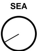
海面反射抑制機能（STC）は、海面からの不要な反射信号を抑制する為に使用します。SEAつまみを時計方向に回すと海面反射信号抑制効果は強くなり、反時計方向に回すと効果は小さくなります。メニューにより AUTO1、AUTO2、または HARBOR (港湾) を選択すると、自動 STC 調整モード、港湾 STC モードに切り替わります。自動 STC 調整モードでは海面反射の強度に応じて、自動的に STC レベルが調整されます。HARBOR モードでは予め設定してある固定レベルの STC 効果が得られ、周辺に防波堤、建物、障害物等が多い場所で有効です。表示はそれぞれ、「AUTO1」、「AUTO2」、「HARBOR」、または「MANUAL」と変わります。「AUTO1」、「AUTO2」、「HARBOR」モードの状態では手動調整はできません。
