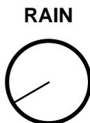
雨雪反射抑制機能（FTC）は、雨や雪からの不要な反射信号を抑制する為に使用します。RAINつまみを時計方向に回すと雨雪反射信号抑制効果は強くなり、反時計方向に回すと効果は小さくなります。メニューにより AUTO1、AUTO2、または HARBOR を選択すると、自動 FTC 調整モードに切り替わります。自動 FTC 調整モードでは、画面上の「RAIN MANUAL」表示が「RAIN AUTO」になります。「RAIN AUTO」表示の状態では手動調整はできません。
