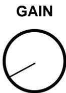
受信感度を調整します。つまみを時計方向に回すと感度は上がり、反時計方向へ回すと下がります。メニューにより AUTO1、AUTO2、または HARBOR を選択すると感度自動調整機能が動作を開始し、画面の「GAIN MANUAL」表示が、「GAIN AUTO1」等になります。自動モード動作中は手動感度調整はできません。
