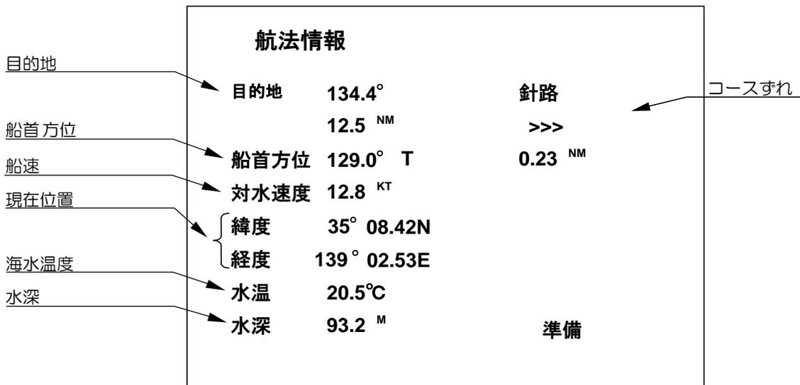
GPSなどの航法装置が、レーダに接続されている必要があります。この画面では、自船の船位・船速、海水温度その他の航法上必要な情報を表示します。
