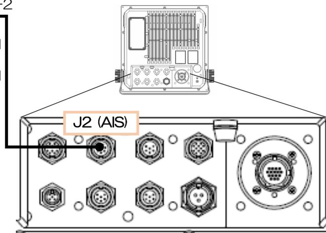
図 3.24 AISケーブルの接続
