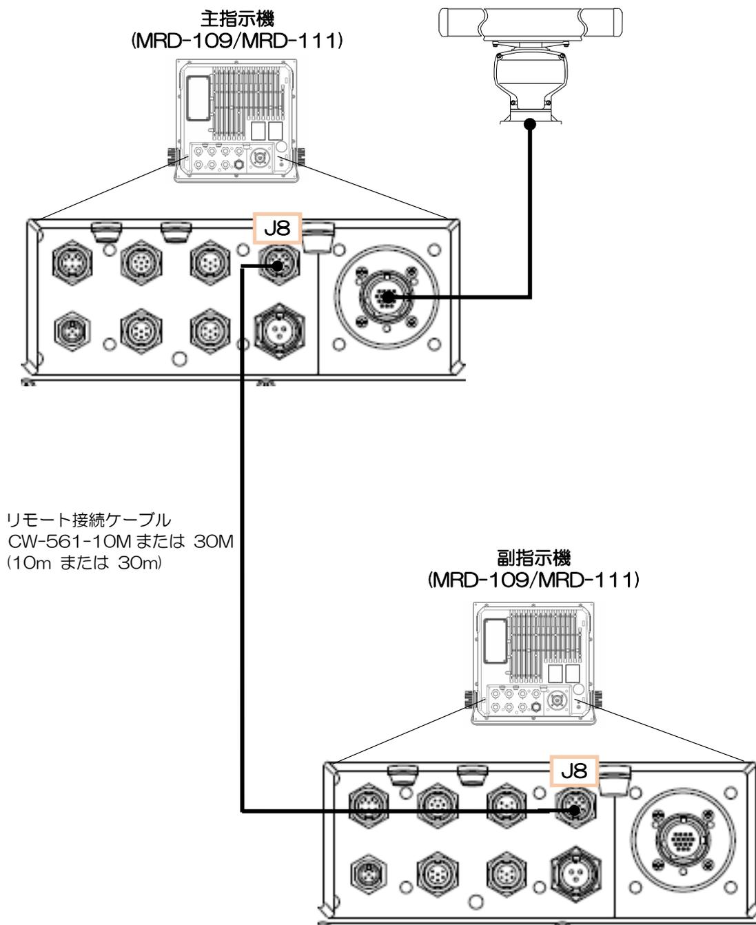
図 3.26 モニター副指示機の接続
