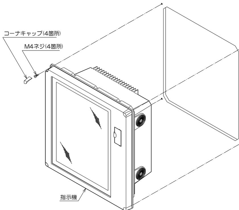
図 3.15 指示機をパネルに取り付ける
