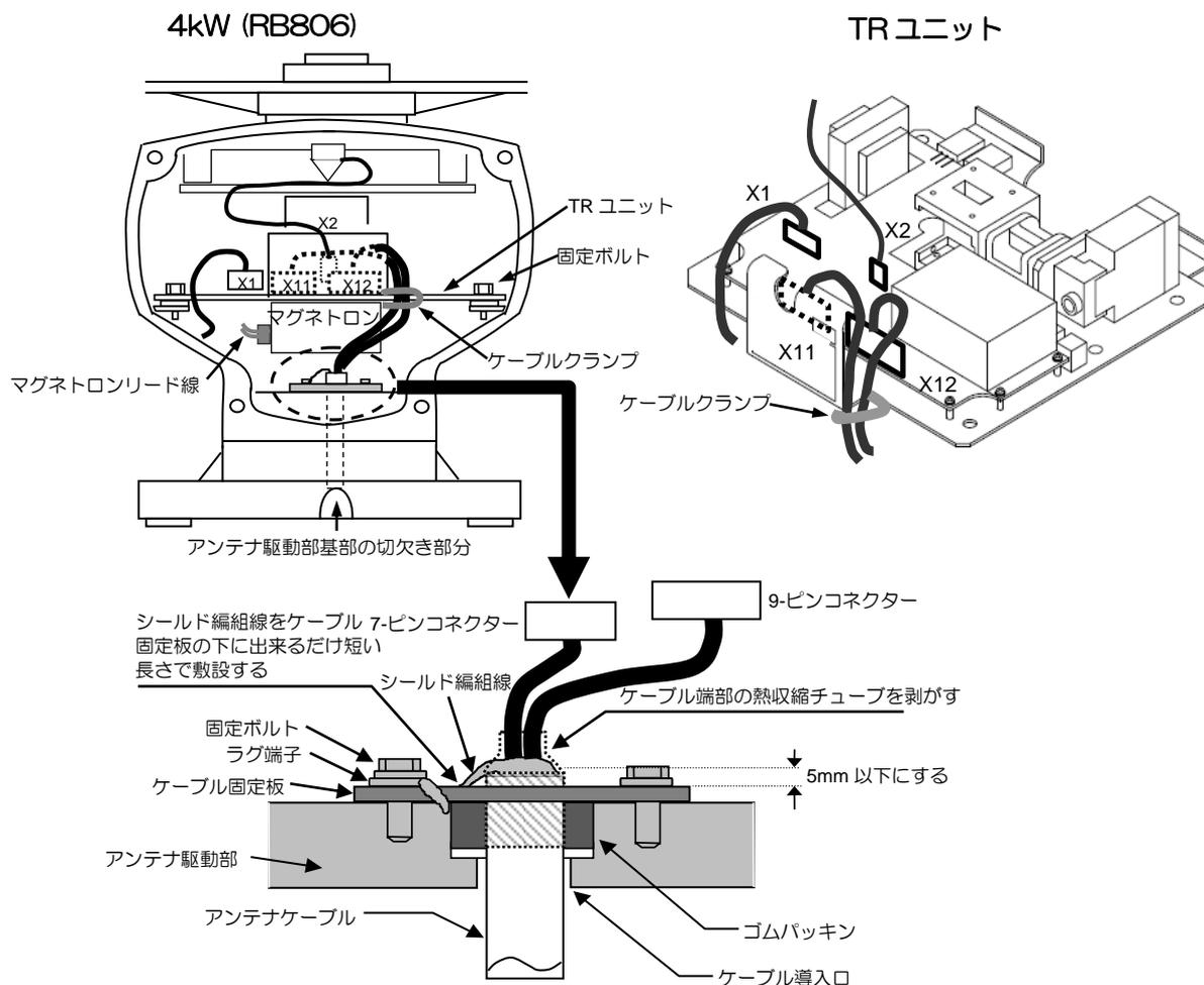
図 3.4.1 空中線駆動部へのケーブル接続
