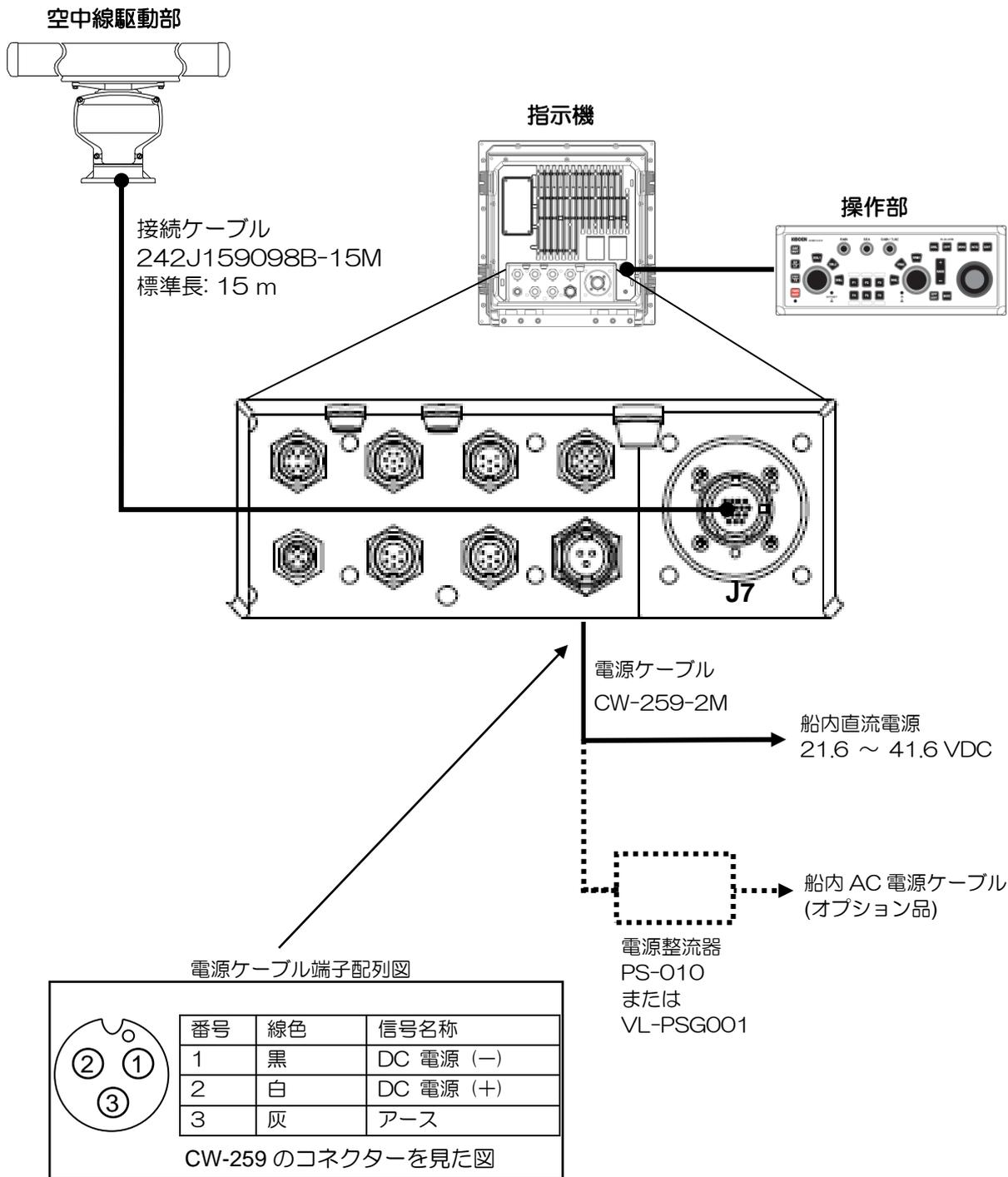
図 3.19 MRD-109 の標準構成のケーブル接続
