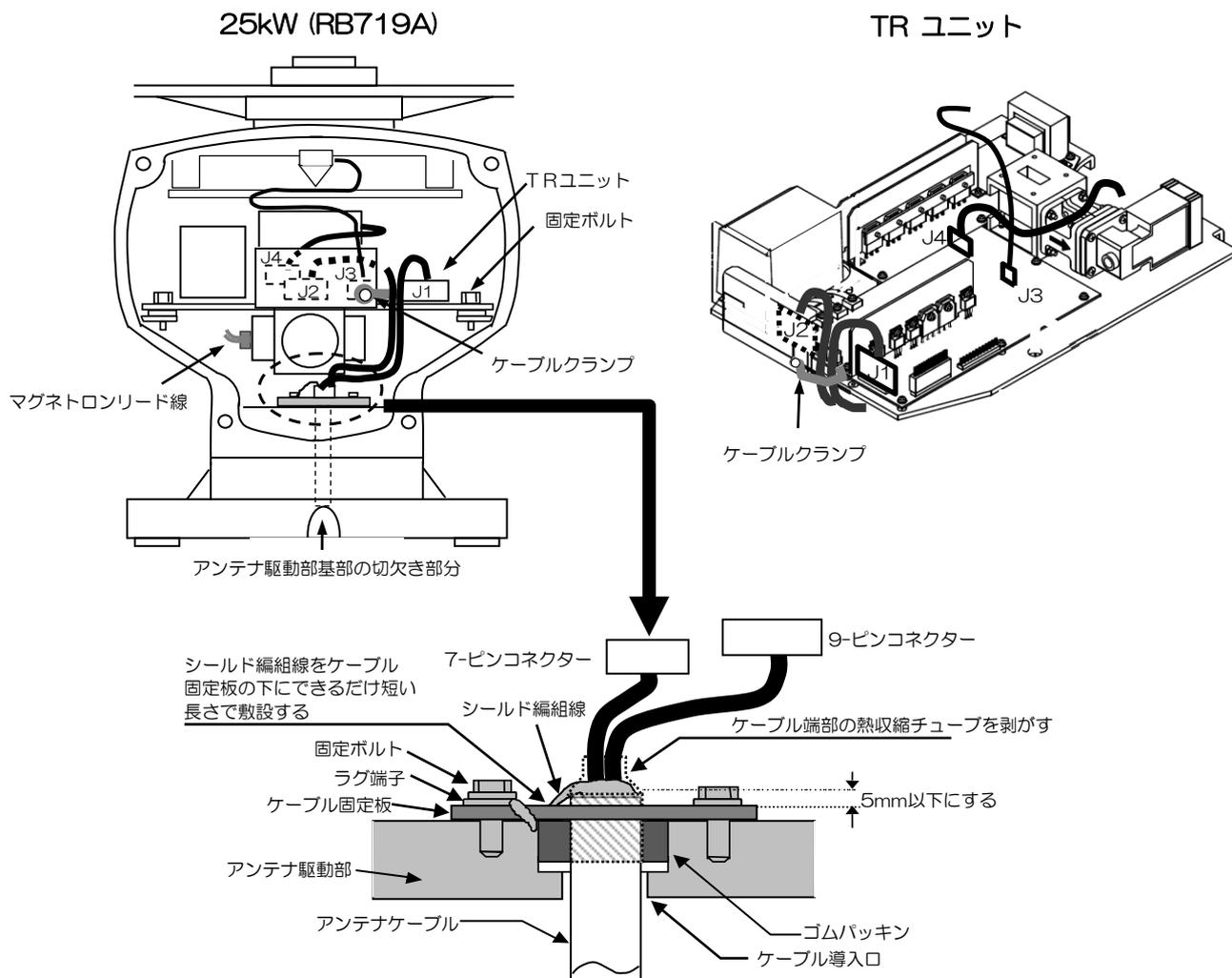
図 3.4.3 空中線駆動部へのケーブル接続
