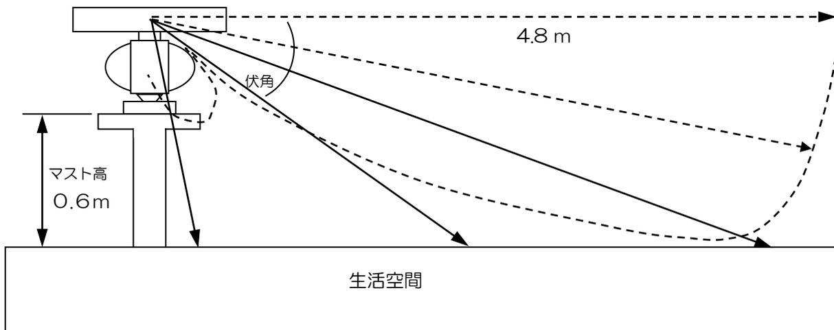
図 0.1 アンテナ設置高と安全距離
