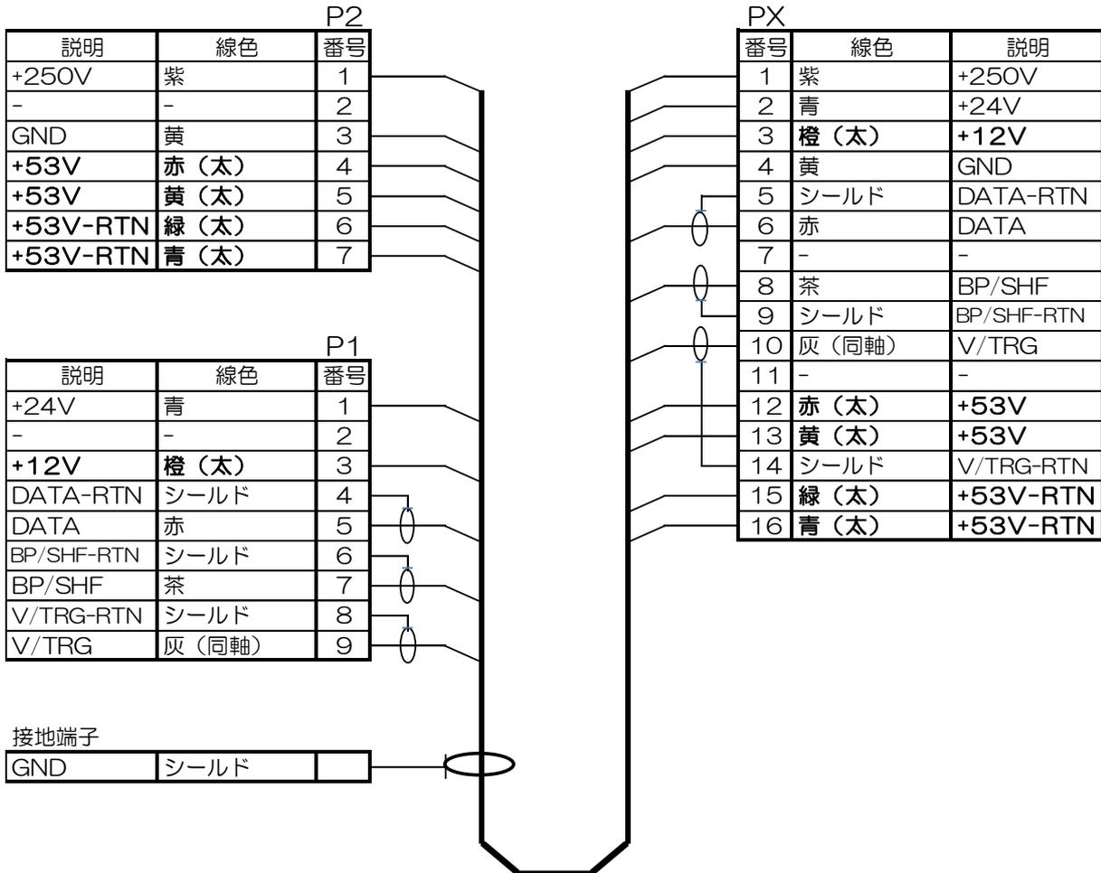
図 3.5 空中線駆動部と指示機間の相互接続
