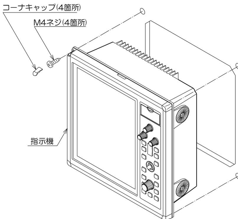
図 3.9 指示機をパネルに取付ける
