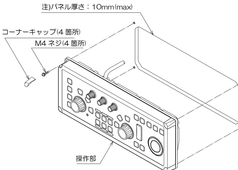
図 3.17 操作部をパネルに取り付ける
