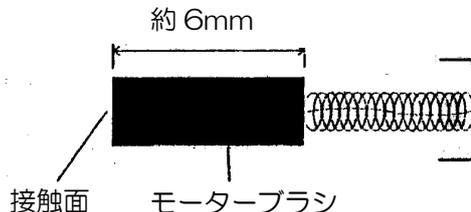
図 6.1 モーターブラシ交換の目安
