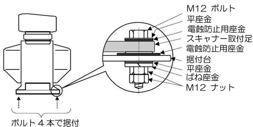
図 3.2 空中線駆動部基部の取付け詳細
