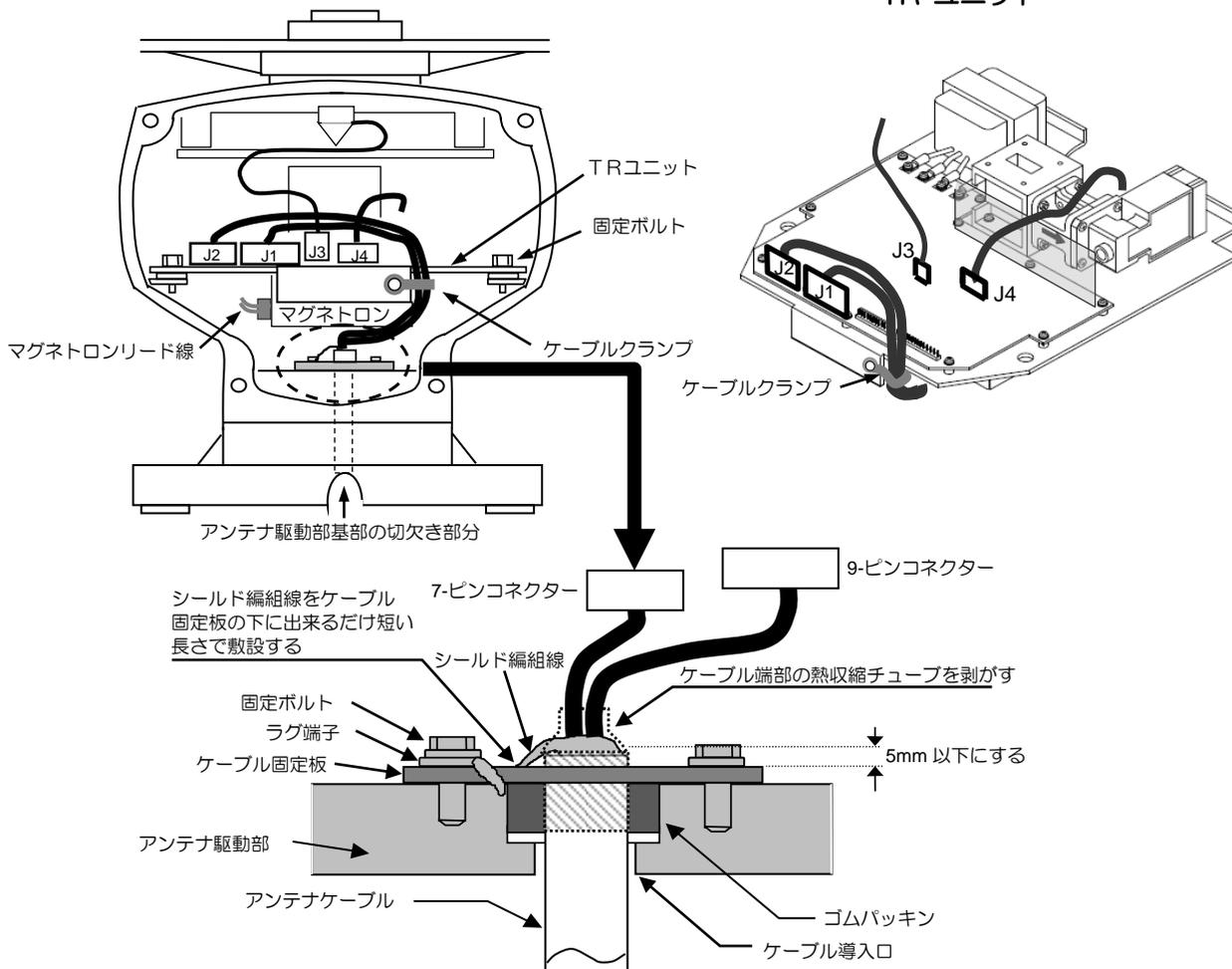
図 3.4.2 空中線駆動部へのケーブル接続
