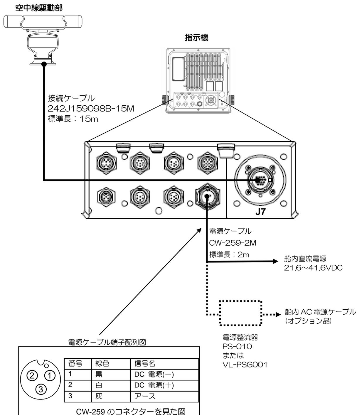
図 3.18 MRD-111 の標準構成品のケーブル接続
