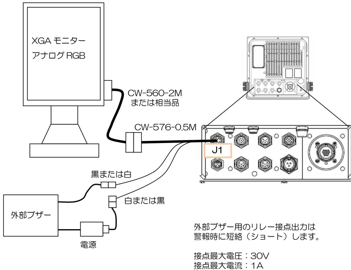
図 3.23 外部モニターおよび外部ブザーとの接続
