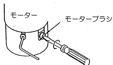
モーターブラシを外すには、ドライバーで反時計方向にゆっくりと回してください。
