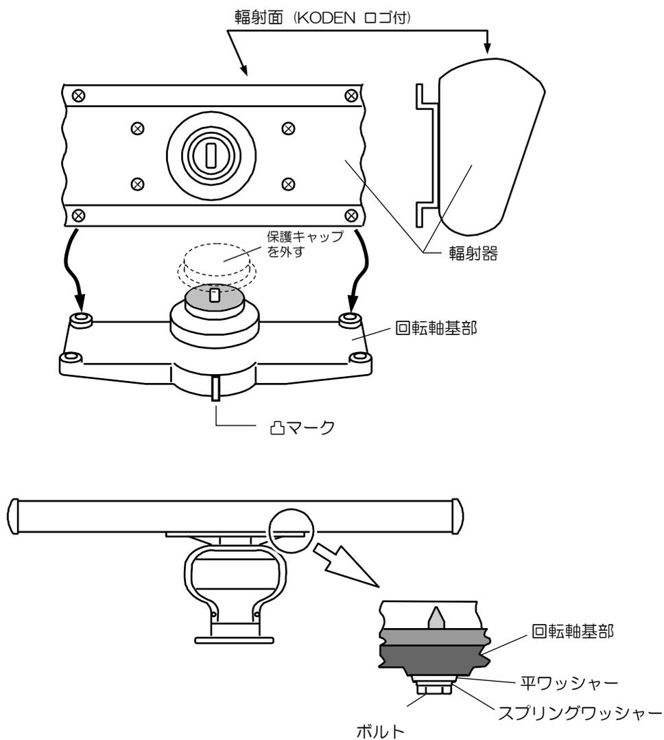
図 3.3 回転軸基部へのアンテナ取付け
