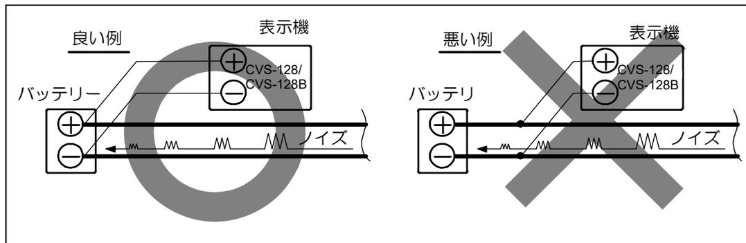
図 5.1 電源ラインの接続方法
