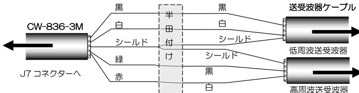
図 5.6.2 CW-836-3M ケーブル接続図
