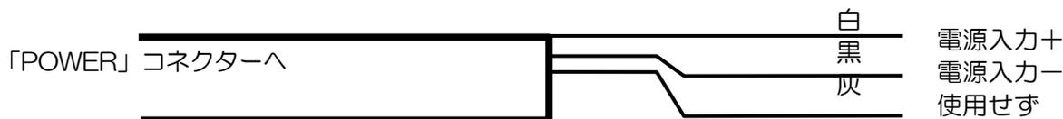
図 5.3.3 DC 電源ケーブルの接続図
