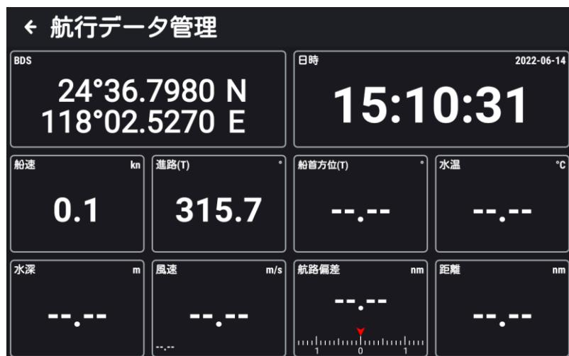
任意のデータ表示枠をタッチすると、表示内容を「自船の緯度経度、船速、進路、HDOP、VDOP、日時、船首方位、水深、風速、水温、対水速度、航路偏差、距離、方位、ETA、リセット」から選択し切り替えることができます。（下図参照）
