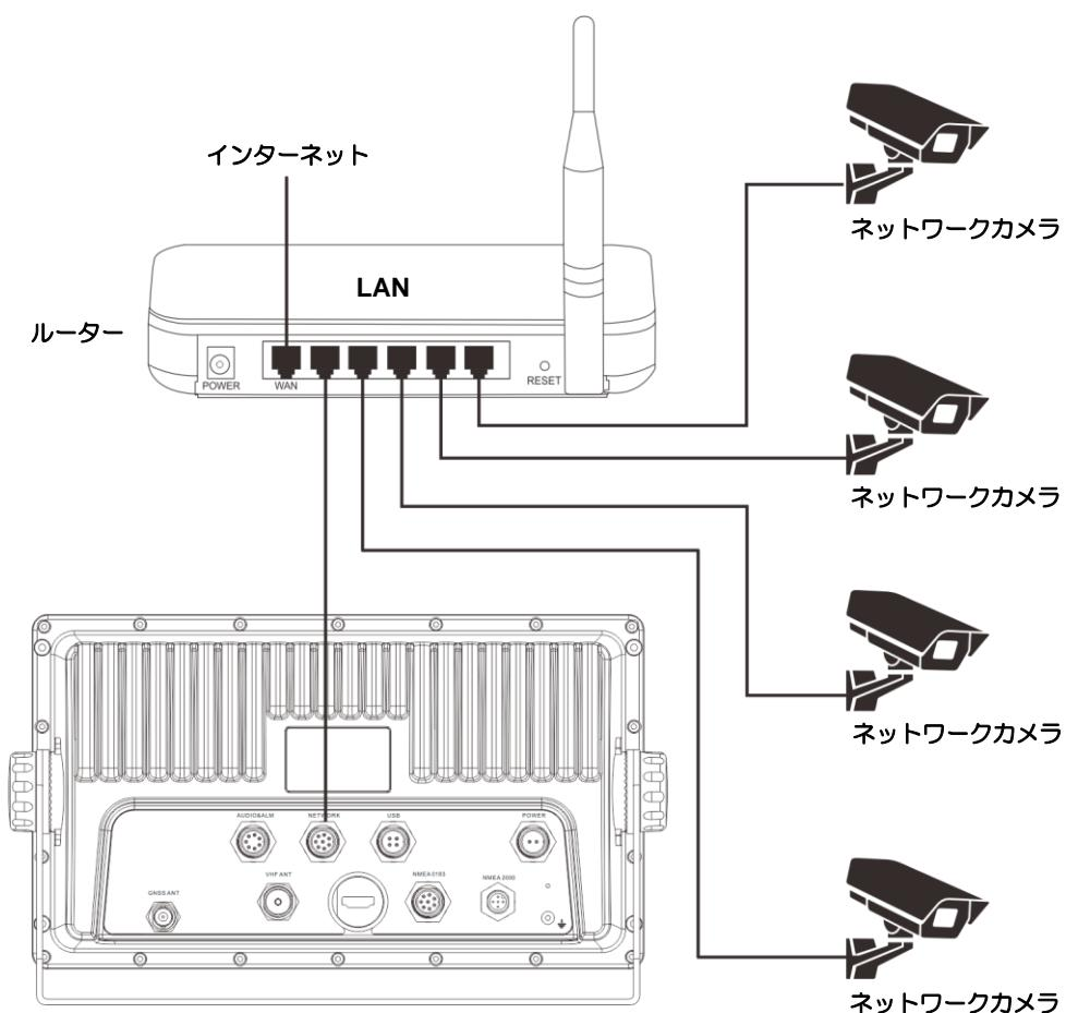
図 2.19：ネットワークカメラ接続図
