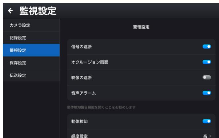
**信号の遮断**：オンに設定すると、断線などで信号遮断が発生したときに警報を発します。
