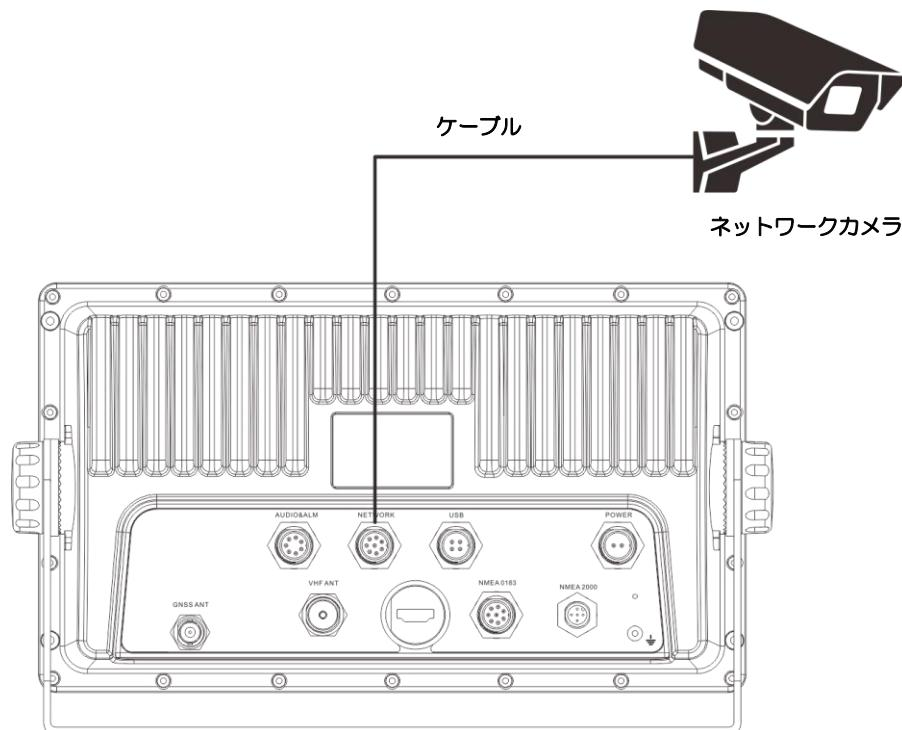
図 2.18：ネットワークカメラ接続図
