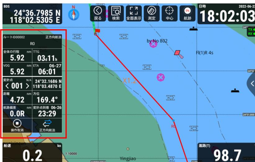
[1]自船の緯度経度、全体の行程（距離）、方位（BRG）、目的地までの所要時間（TTG）、残り航海距離（VOG）、航路偏差（XTE）、到着予定時刻（ETA）などが表示されます。「操作取消」をタッチし、ルート航法を終了します。
