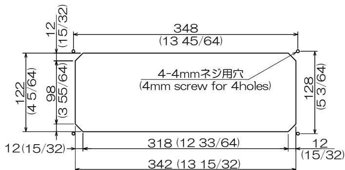
図 3.15 操作部取付け穴加工図
