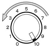
◎機能設定の“TVG カーブ”で“泡消し”を選択している場合、このツマミは自船（海面）付近の気泡や汚れを消す「STC」機能になり反時計方向へ回すと自船（海面）付近から遠い方（深い方）へ気泡や汚れを消していきます。
