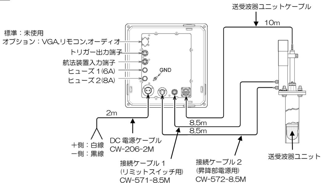
※電源ケーブルにブレーカーを設けた場合、または配電盤から電源を供給する場合は、直接ブレーカーまたは配電盤で電源を切らないようにして下さい。
