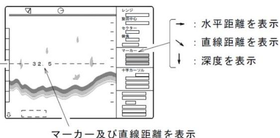
\*魚探モード時は送受波器からの直線距離となり、ソナー時と同様にマーカー情報が表示されます。
