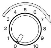
◎機能設定の“TVG カーブ”で“10LOG~40LOG”のいずれかを選択している場合、このツマミは遠い方（深い方）の感度を調整する機能になり、時計方向へ回すと自船（海面）付近の感度は変わらず、距離が遠く（深度が深く）なるにつれて感度が増すように TVG カーブの補正をします。 参照 3-7
