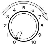
◎ツマミを時計方向（右方向）に回すと画面の明るさが増します。
