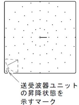
※自動格納機能を設定していても、送受波器ユニットが格納終了するまでは船速を 15kt（27km/h）以下にしてください。
