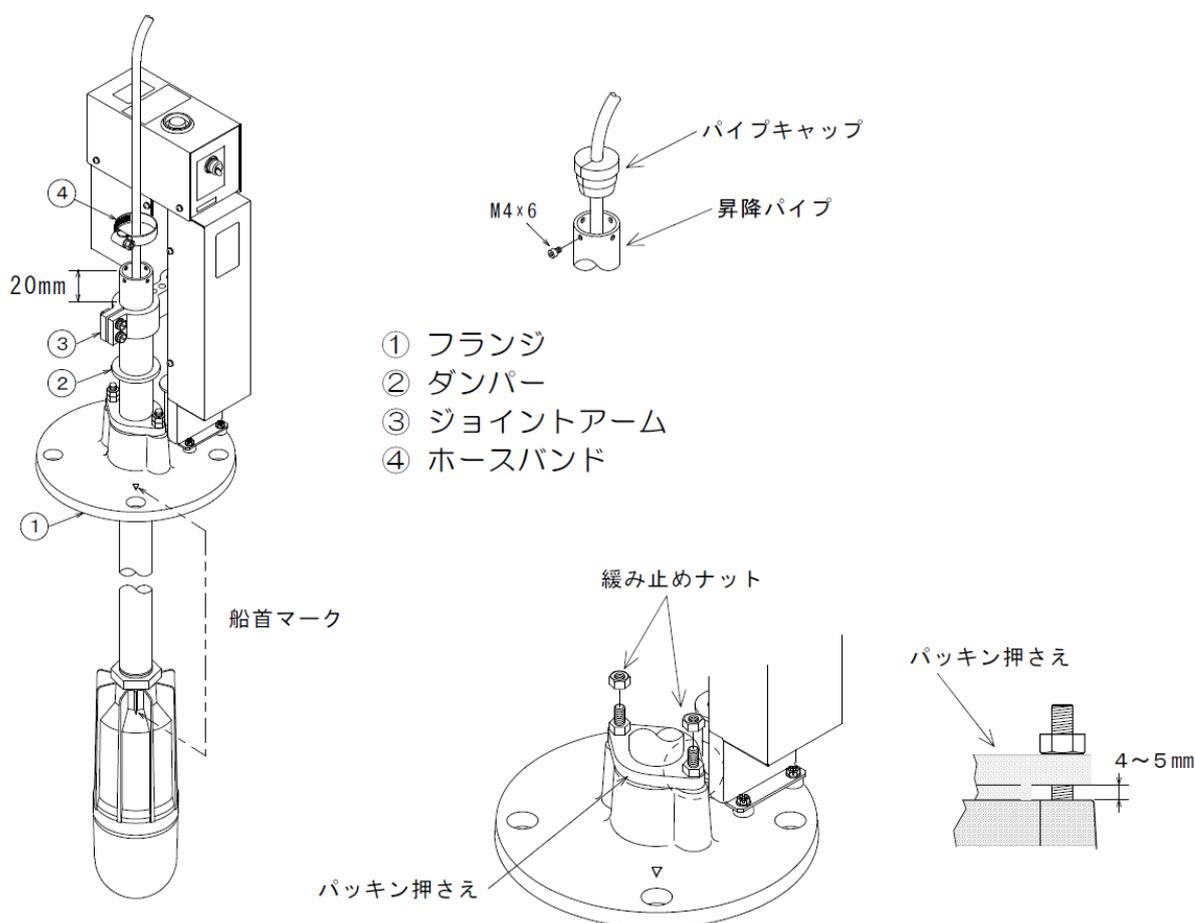
\* 送受波器ユニットと昇降部の組付けが完了したら、パッキン押さえの調節をします。
