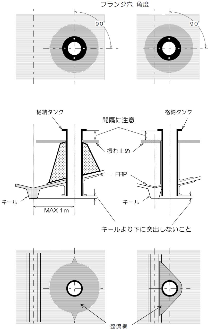
• 格納タンクのフランジ下面には、フランジのボルト締めを支障をきたす障害物がないように設置して下さい。
