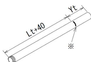
※ Lt+40 の位置に印を付けてジョイントアームの上端をこの印に合わせて締め付けます。
