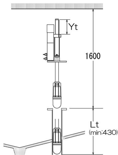
フランジ上部作業空間に左図の余裕があれば昇降パイプを切断せずに使用できます。
