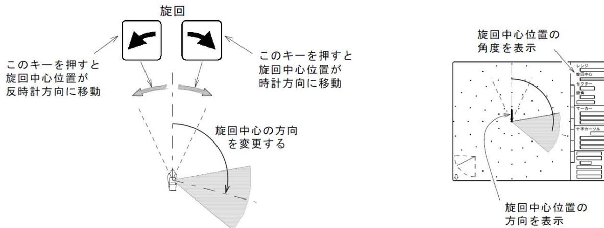
◎サイドスキャンモードのときは、探索（スキャン）する方向を5° ステップ毎に移動します。
