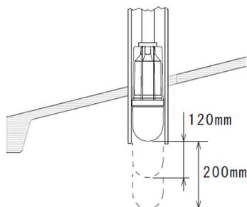
\*昇降部に電源が供給されているときにリミットスイッチの位置を変更する場合には、必ずモーター電源用スイッチを“OFF”にしてから作業を行ってください。
