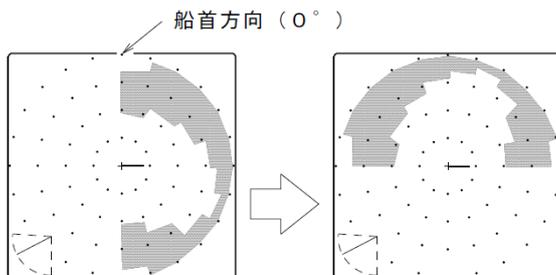
[例]・旋回中心位置 90° を船首方向にセットした場合は、左図のように 90° 左に回した画像表示になります。
