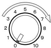
◎受信感度を調整するツマミで、時計方向に回すと感度が増します。
