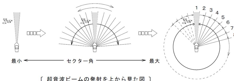
◎送受波器の傾き（俯角）を変えることにより、超音波ビームを自船真下から水平方向まで可変することができます。
