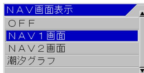
2. 「▲」、「▼」を押し、NAV 画面 1 の航法画面を変更するときは、[NAV 画面 1]を選択します。NAV 画面 2 の航法画面を変更するときは、[NAV 画面 2]を選択します。
