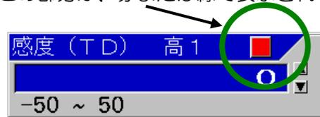
感度 (TD) の合わせ方として、海底を示すホワイトラインが全画面で同じくらいの太さになるように設定値を合わせます。
