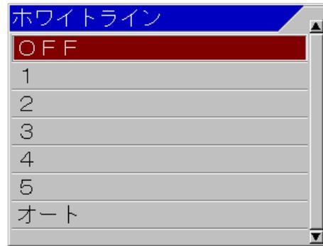
4. 「▲」、「▼」を押し、ホワイトラインの線の太さを選択します。1 が最も細く、5 が最も太く表示されます。オートは海底反射強度に応じてホワイトラインの太さが変化します。表示をやめるときは、[OFF]を選択します。
