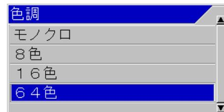
4. 「▲」、「▼」を押し、変更する色調を設定します。設定に対応してレインボーパターンも変更されます。
