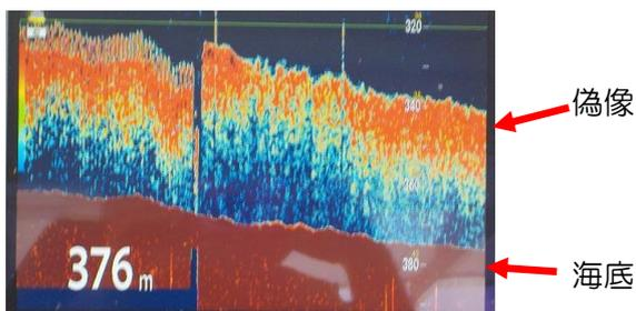
送信間隔は次回を送信を始めるタイミングを調整して残響の期間を回避させます。
