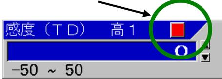
感度 (TD) の合わせ方として、海底を示すホワイトラインが全画面で同じくらいの太さになるように設定値を合わせます。
