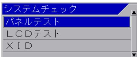
4. 「▲」、「▼」を押し、パネルテスト、またはシステム状態の確認を行うときは、[パネルテスト]を選択します。LCDのチェックを行うときは、[LCDテスト]を選択します。XIDデータを確認するときは、[XID]を選択します。
