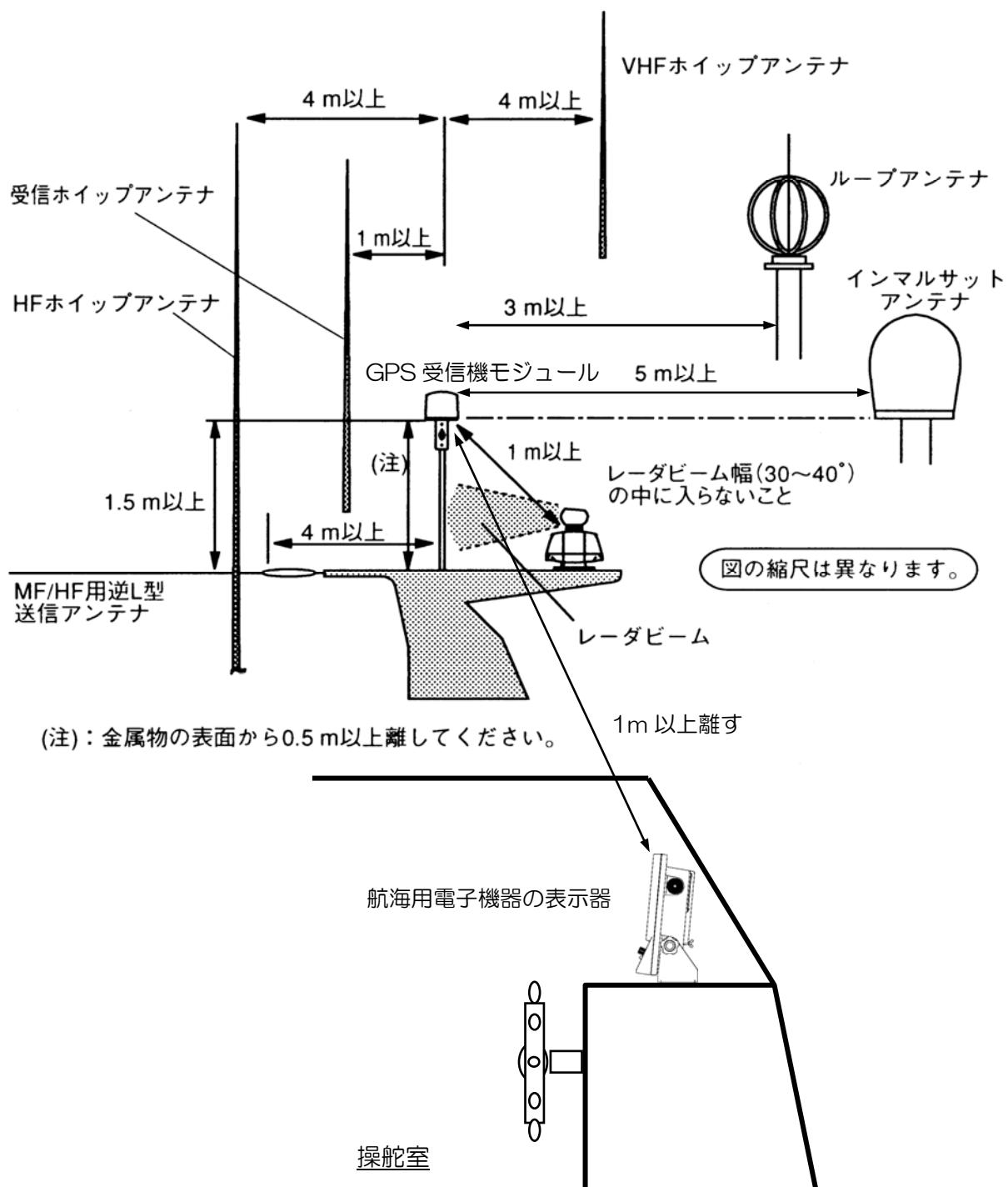
図2.1 GPS受信機モジュールの推奨取付け位置
