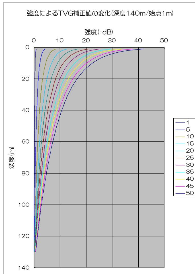
グラフ内の左端の線が強度 1、右端の線が強度 50
