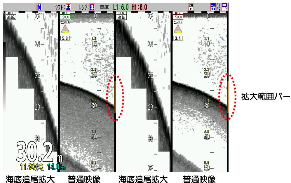
指定した拡大レンジで、画面の上から 30%と 90%の範囲内に海底を表示するよう、自動的にシフト表示します。
