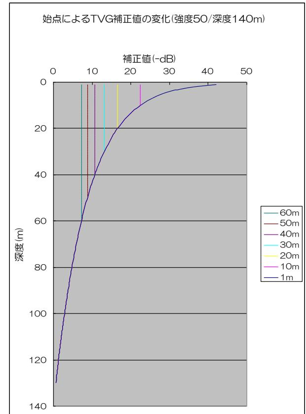
グラフ内の左端の線が補正深度 60m、右端の線が補正深度 1m
