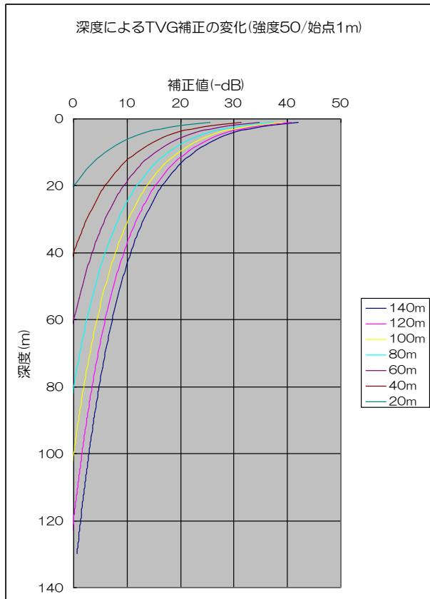
グラフ内の左端の線が補正深度 20m、右端の線が補正深度 140m
