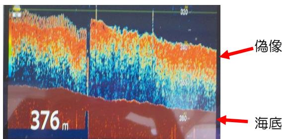
送信間隔は次回の送信を始めるタイミングを調整して残響の期間を回避させます。
