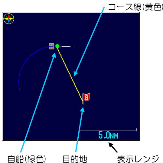
「コンパス」は、自船の進路を上方向として表示し、風の方向を矢印で表示します。また、目的地航法時は、目的地方向に旗を表示します。
