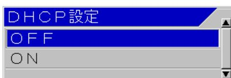
4. 「▲」、「▼」を押し、DHCPサーバーからIPアドレスを取得するときは、[ON]を、手動で設定するときは、[OFF]を選択します。
