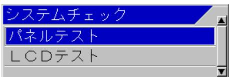
4. 「▲」、「▼」を押し、パネルテスト、またはシステム状態の確認を行うときは、[パネルテスト]を選択します。LCD のチェックを行うときは、[LCD テスト]を選択します。
