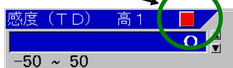
感度(TD)の合わせ方として、海底を示すホワイトラインが全画面で同じくらいの太さになるように設定値を合わせます。
