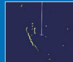
海面反射除去+雨雪反射除去
